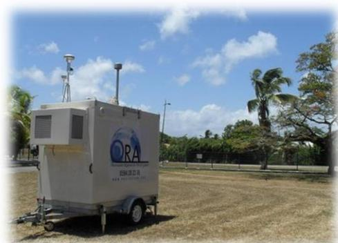
et demandes. Elles sont équipées d'appareils pour la surveillance des NO<sub>x</sub>, O<sub>3</sub> et des PM<sub>10</sub>, mais peuvent aussi l'être pour la mesure du CO ou du SO<sub>2</sub>.
