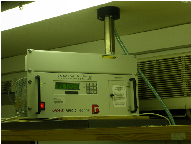
Figure 5 : Vues de l'intérieur de la station, analyseur Grimm 180 (à gauche) et analyseur TEOM (à droite)
