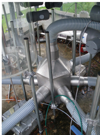
Figure 3 : Vue du dispositif de distribution
