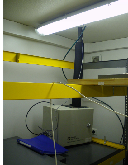
Figure 5 : Vues de l'intérieur de la station, analyseur Grimm 180 (à gauche) et analyseur TEOM (à droite)
