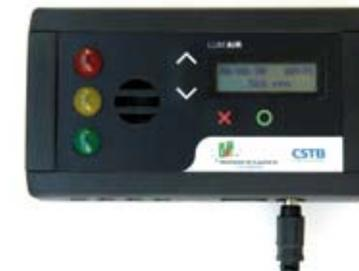
Lum'Air, appareil de mesure du confinement
