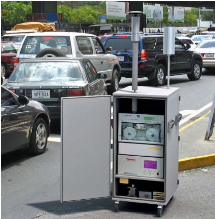
Figure 12 : l'appareil ROADPOINTER de la société RECORDUM
