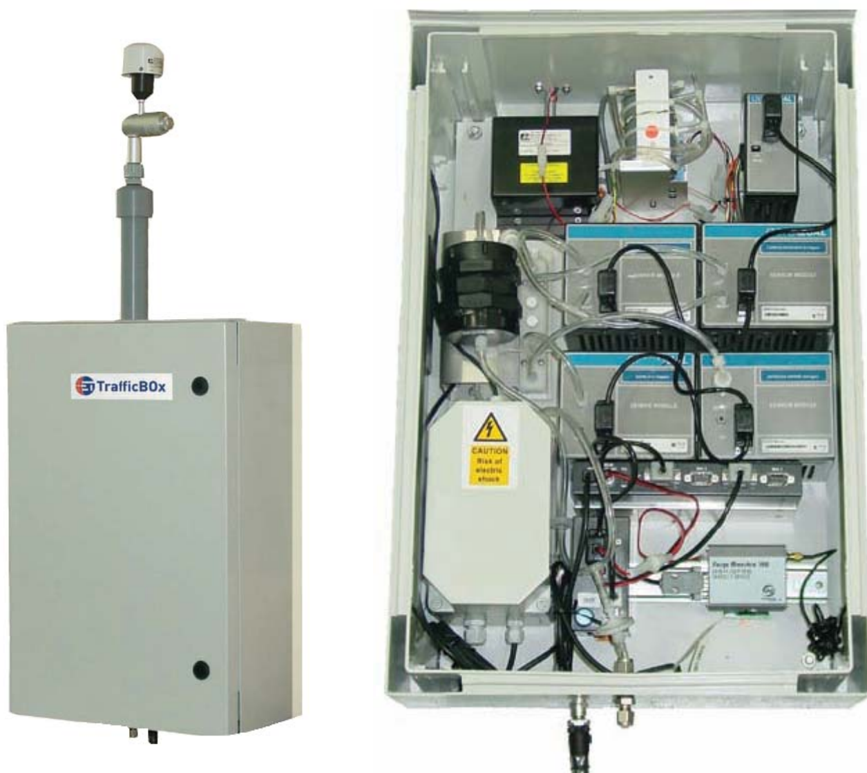
Figure 14 : le système multigaz TrafficBox de la société Enviro Technology
